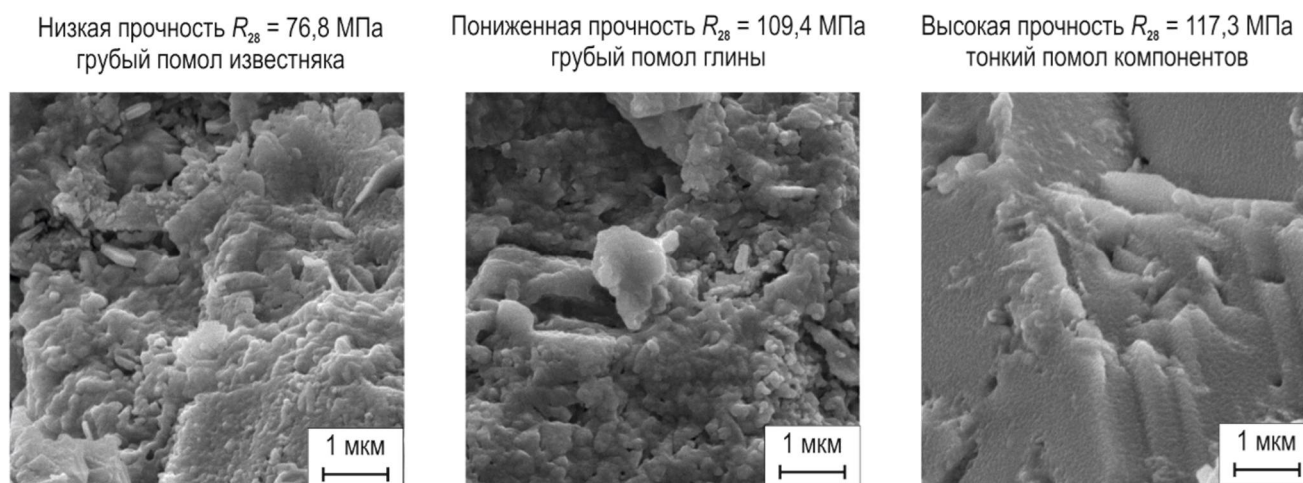
Рис. 7. Микроструктура цементного камня при пониженной и повышенной прочности в 28 сут
