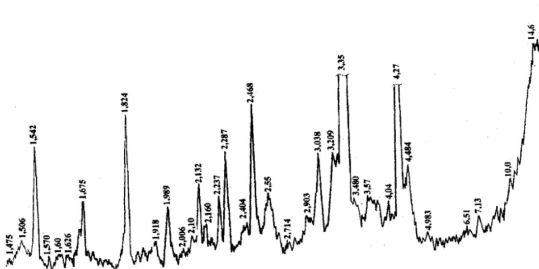
Рис. 1. Рентгенограмма усредненной пробы суглинков Дорожного месторождения
