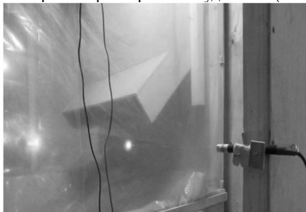
Рис. 5. Средства контроля параметров пылеудаления (световой излучатель) и нижний конец выгрузного лотка.
