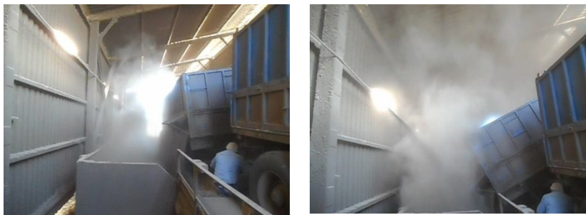
Рис. 1. Процесс пылеобразования при выгрузке сырья в завальную яму.
