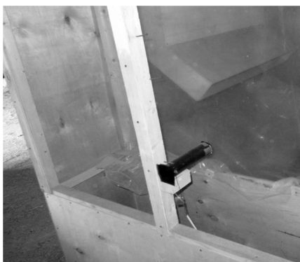
Рис. 4. Средства контроля параметров пылеудаления (оптический датчик).
