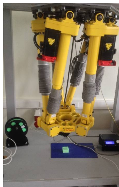
Рис. 6. Робототехнический комплекс для 3D-печати изделий
