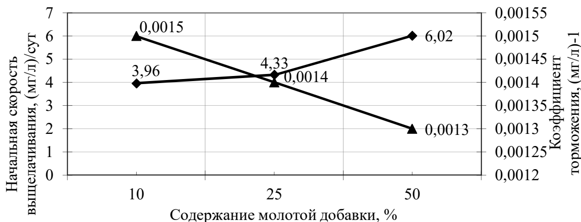
Рис. 5. Изменение начальной скорости и коэффициента торможения в зависимости от дозировки молотой полевошпатовой породы
