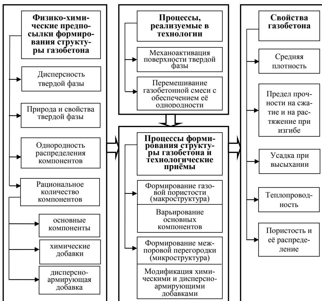
Рис. 1. Схема информационных логических связей при формировании структуры газобетона из предварительно приготовленной сухой смеси
