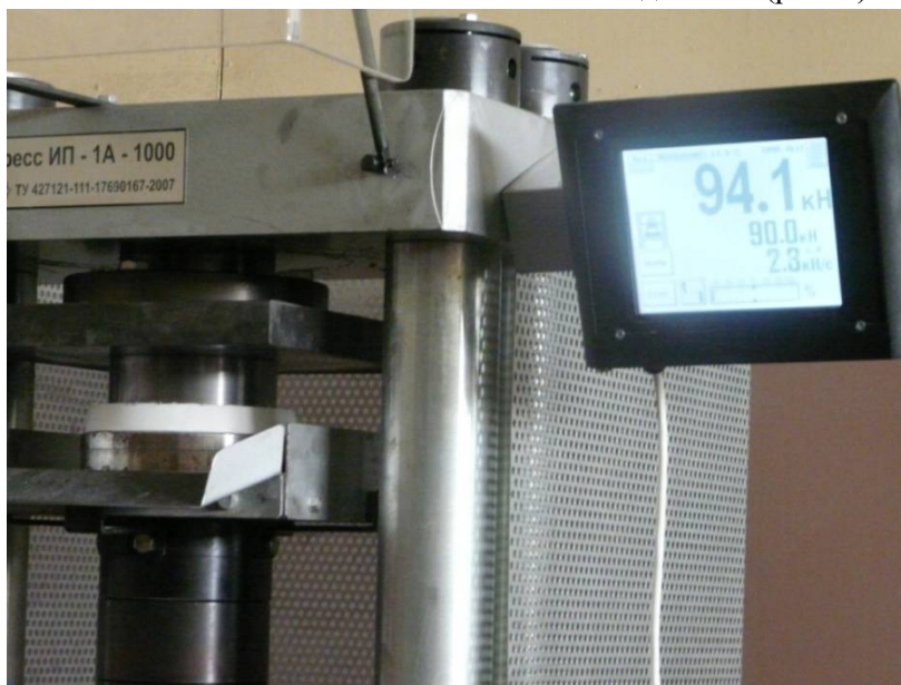
Рис. 3. Испытание раструбного сварного соединения на сдвиг сжатием на машине ИП-1А-1000
