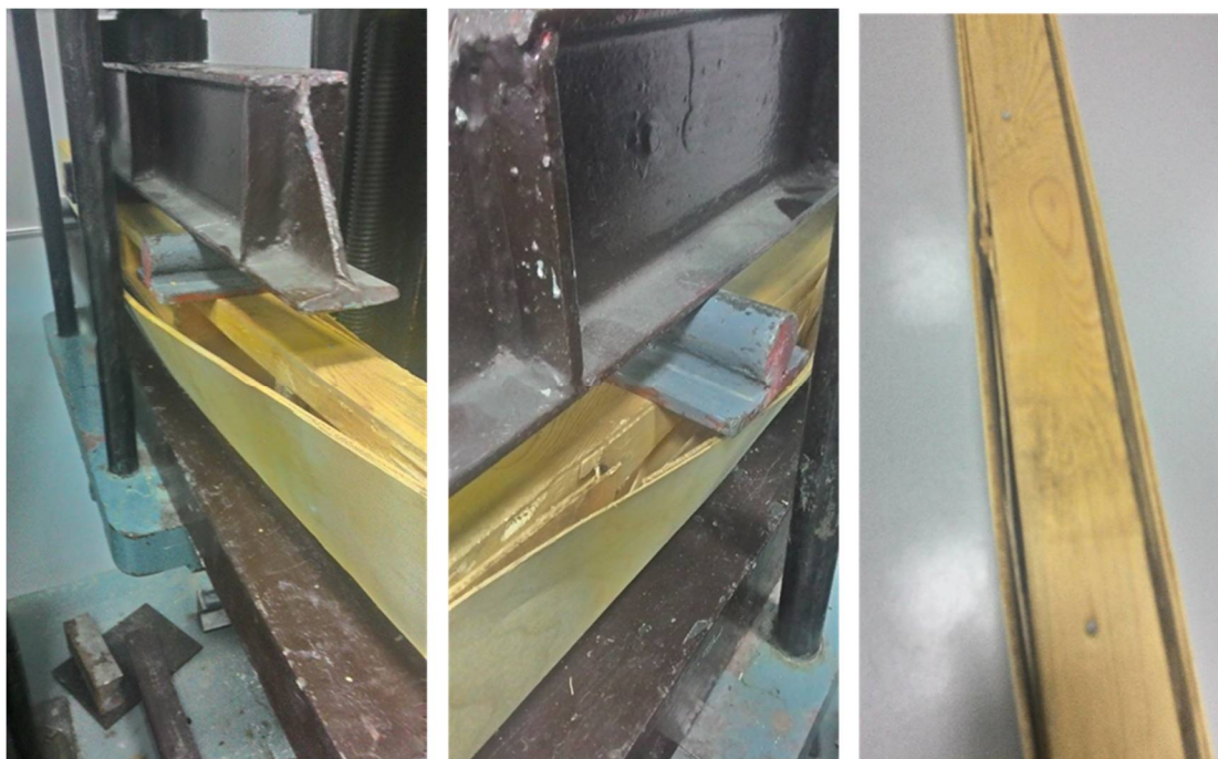
Рис. 4. Характер разрушения образца фанерной клееной балки
