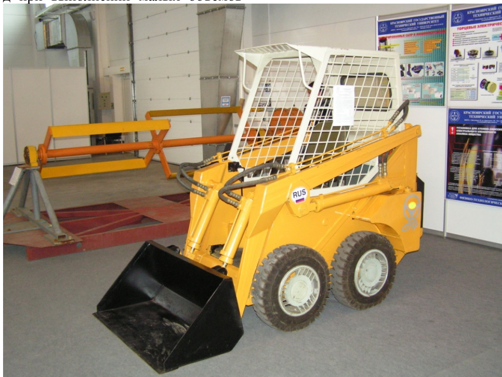
Рисунок 1. Универсальный малогабаритный погрузчик «Соболь», разработка Сибирского Федерального университета и Красноярского завода прицепной техники (г. Сосновоборск)
