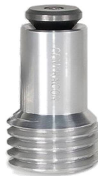
Рис. 9. Сопла для трубной очистки серии RTC 360° из карбида вольфрама, срок службы – до 400 часов, оболочка – алюминий. Резьба – 50 мм. Входной диаметр – 32 мм. Диаметр и длина сопла: 8.0×75 мм
