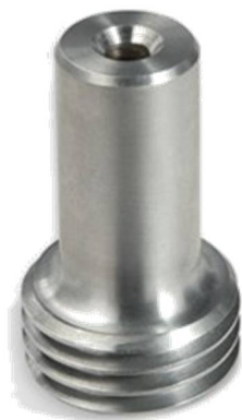
Рис. 8. Сопла Вентури из карбида вольфрама серии МТС. Срок службы – до 400 часов; оболочка – алюминий; резьба – 50 мм, входной диаметр – 25 мм. Диаметр и длина сопла, мм: 5.0×80; 6.5×80; 8.0×80; 9.5×80; 11.0×80; 12.5 ×80
