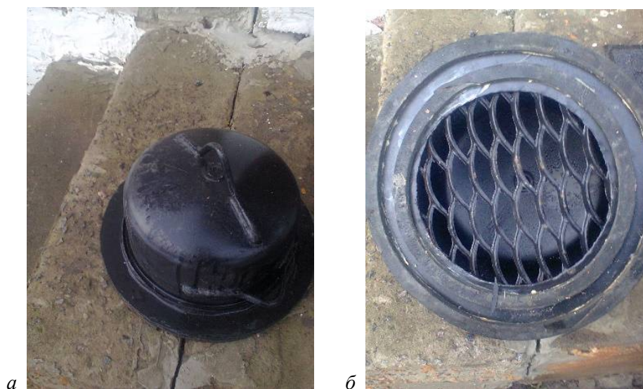
Рис. 3. Конструкция башмака выносных аутригеров: а – общий вид; б – вакуум основание
