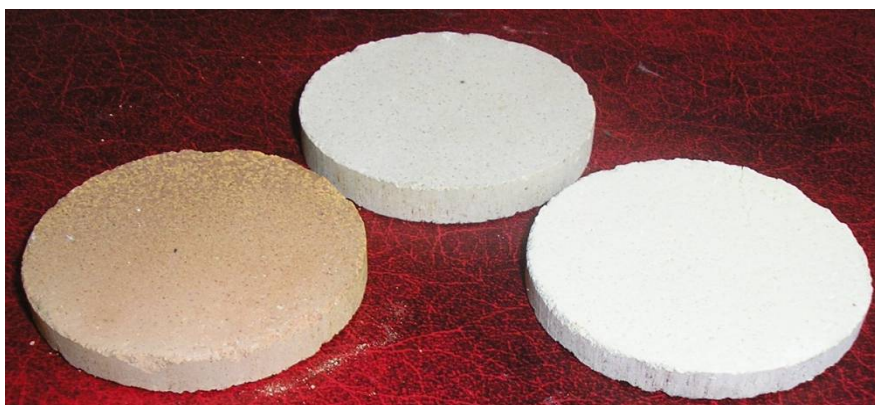
Рис.5. Общий вид образцов радиационно-защитной керамики с различным содержанием \text{Bi}_2\text{O}_3
