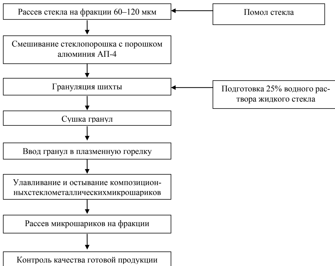
Рис. 1. Технологическая схема получения композиционных стеклометаллических микрошариков
