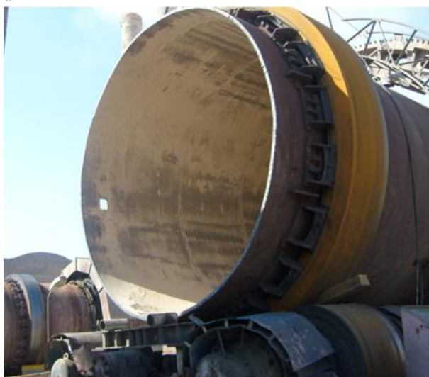
Рис. 1. Бандажи вращающихся технологических барабанов: а – плавающего типа – «П», б – вварные – «В»
