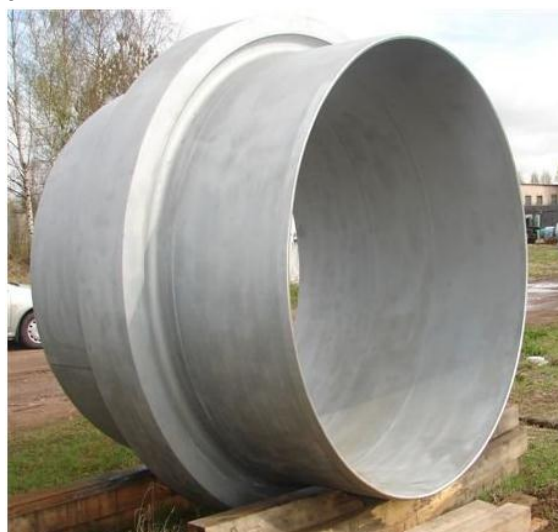
Рис. 1. Бандажи вращающихся технологических барабанов: а – плавающего типа – «П», б – вварные – «В»
