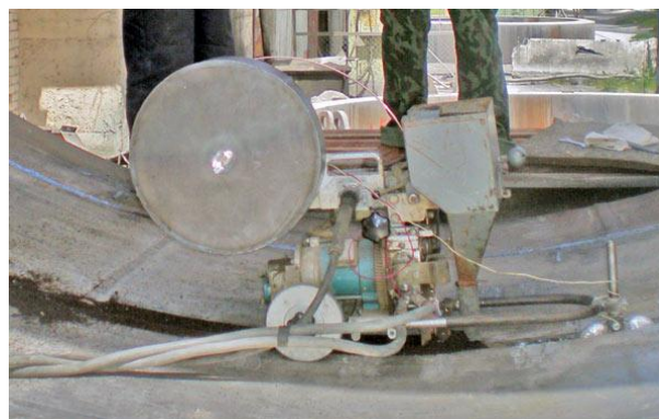
Рис. 9. Сварка реконструированного бандажа с корпусом ТБ (операция 030)
