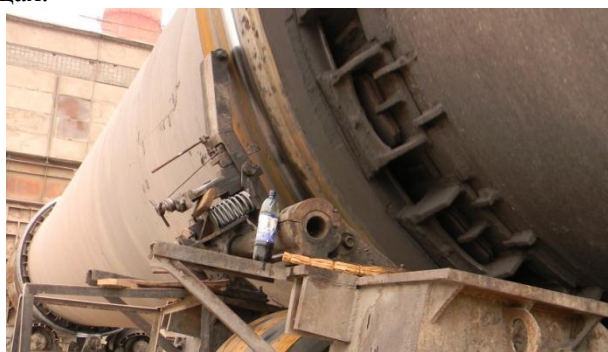
Рис. 2. Обработка поверхности качения бандажа перед его демонтажом с ТБ (операция 010)
