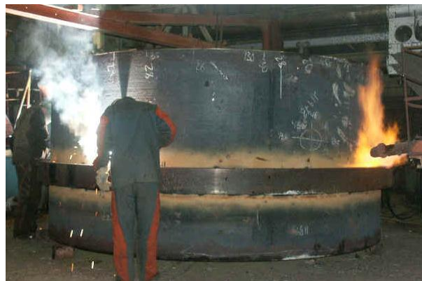
Рис. 8. Сборка бандажа с кольцевыми обечайками, с использованием сварки с предварительным нагревом (операция 025)
