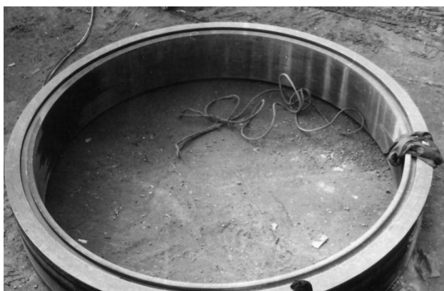
Рис. 6. Бандаж типа «П» реконструированный в тип «В» (операция 020)
