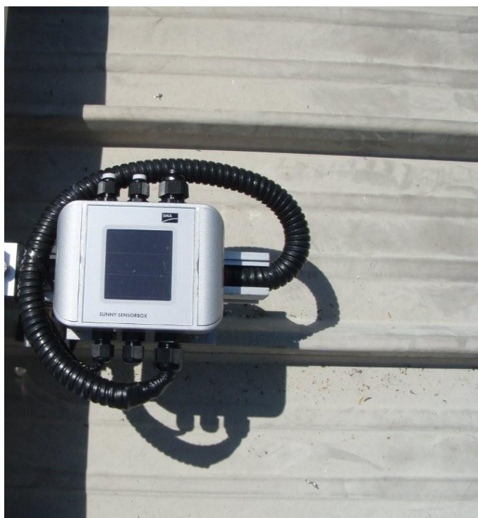
Рис. 1. Датчик инсоляции Sunny Sensorbox от компании SMA Solar Technology AG
