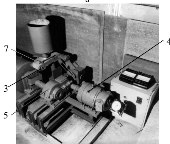
Рис. 1. Экспериментальная установка шаровой мельницы Привод шаровой мельницы 0,5x1,95м 1 - разгрузочная часть барабана, 2- цапфа, 3- приемное устройство загрузочной цапфы, 4- электродвигатель постоянного тока, 5- редуктор, 6- загрузочная часть барабана, 7- питающее устройство, 8 – лопасть двойного действия, 9- лопастной эллипсный сегмент
