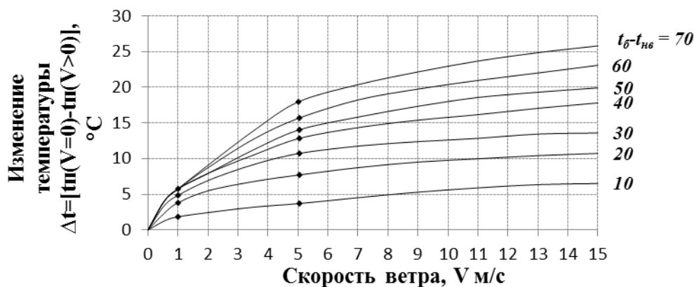
Рис. 2. Изменение температуры поверхности фанерной палубы ( R=0,175 \text{ м}^2 \cdot \text{°C}/\text{Вт} ) от действия ветра ( V=0 \dots 15 \text{ м}/\text{с} ): зависимость величины отклонения \Delta t от скорости ветра и величины температурной разности t_{\sigma} - t_{нв} . Принятый коэффициент конвективной теплоотдачи подчиняется зависимости \alpha_k = 3,25 + (6 \cdot V)^{0,8} , \text{Вт}/\text{м}^2 \cdot \text{°C} ; \varepsilon = 0,95
