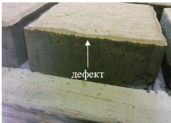
Рис. 3. Дефект изделия при распалубке
