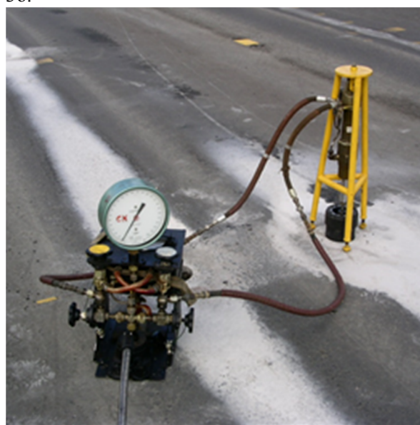
Рис. 2. Оценка сцепления слоев асфальтобетона в покрытии
