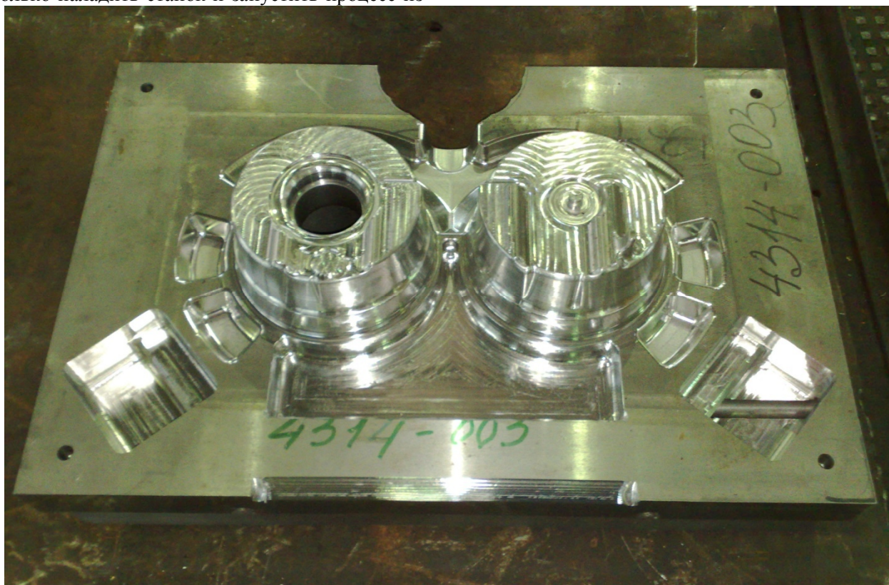
Рис. 1. Пресс-форма (полуформа) для литья под давлением «Корпус масляного фильтра», изготовленная на обрабатывающем центре OKUMO MILLAC761V
