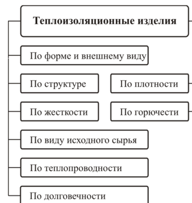
Рис. 4. Сегментирование теплоизоляционных материалов по основным признакам.
