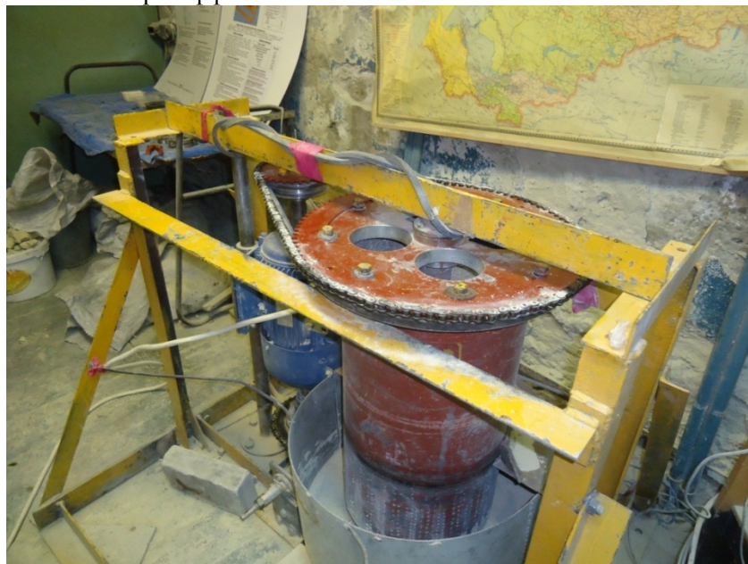
Рис. 1. Измельчитель динамического самоизмельчения с силовым замкнутым контуром
