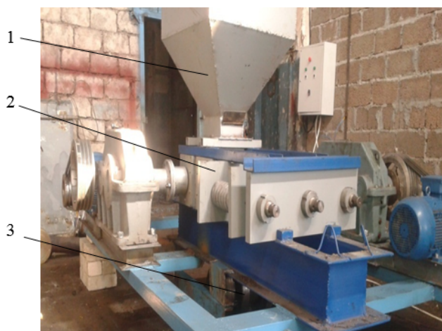
Рис. 3. Пресс-валковый измельчитель с устройством для дезагломерации материалов: а) схема, б) опытно-промышленная установка
