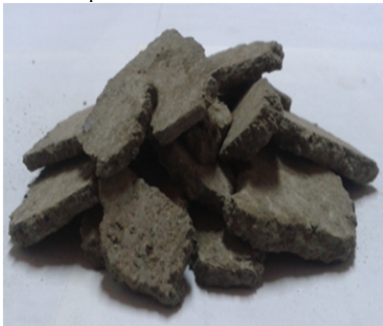
Рис. 1. Форма клинкера, предварительно деформированного в ПВИ
