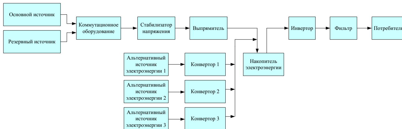
Рис. 2. Структурная схема системы электропитания с несколькими источниками МРЭ
