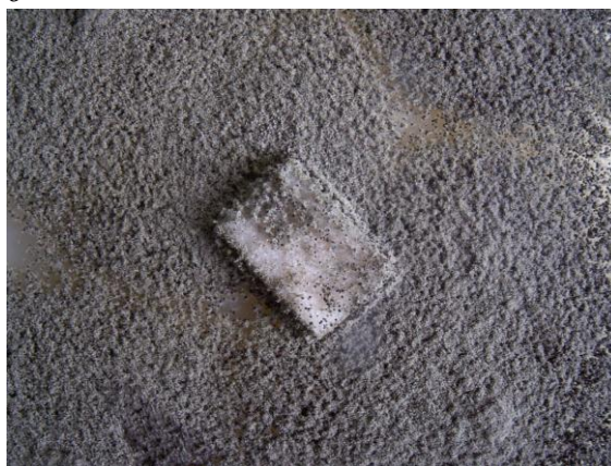
Рис. 1. Характер роста Aspergillus niger на питательной среде Чапека-Докса с образцами полиэтилена, где: а - ПЭ (без наполнителя); б - ПЭ + 50 % крахмала
