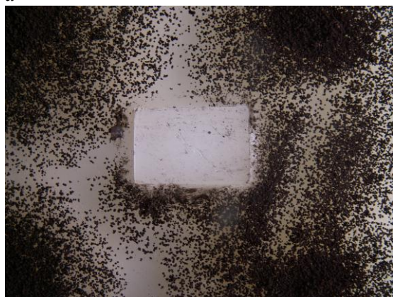
Рис. 1. Характер роста Aspergillus niger на питательной среде Чапека-Докса с образцами полиэтилена, где: а - ПЭ (без наполнителя); б - ПЭ + 50 % крахмала
